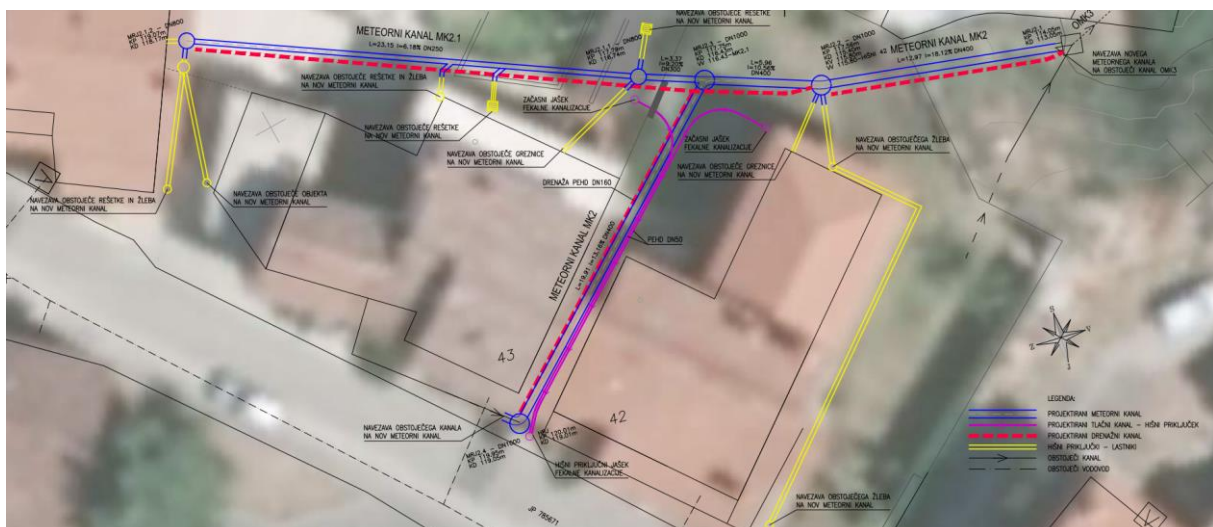
Slika 5: Izveden meteorni kanal MK2
